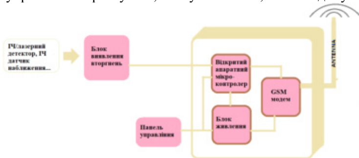
Рис. 1. Структурна схема системи безпеки з GSM комунікатором.
