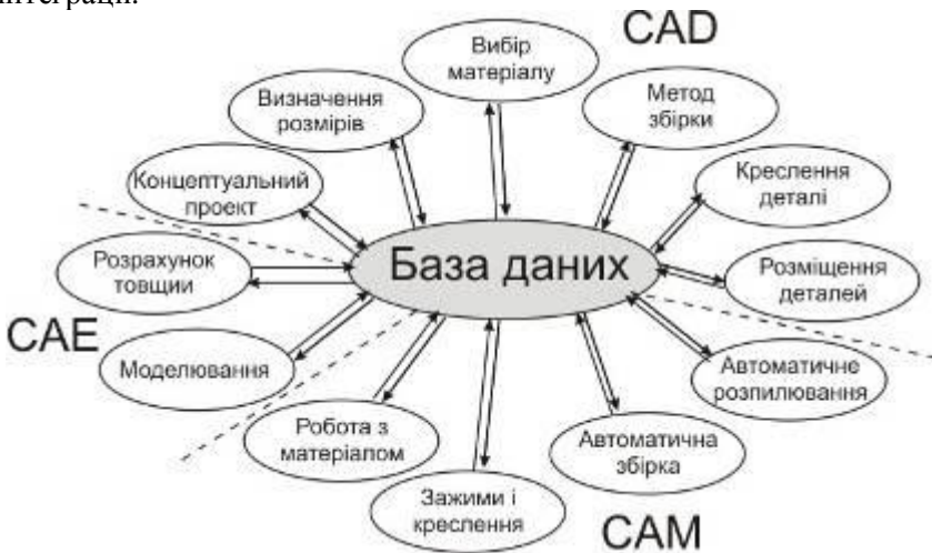
Рис. 1. Інтеграція CAD, CAM і CAE через базу даних
